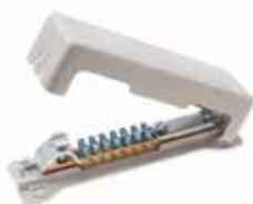
**kleine Ausführung, für Hausanschlüsse 100A, aus Messing vernickelt, mit Kunststoffabdeckung (plombierbar). Anschlüsse bestehend aus:** 7xLeitung bis 25mm<sup>2</sup>, 1xErdungsband 30x4 mm, 1xRundleiter 8–10mm
