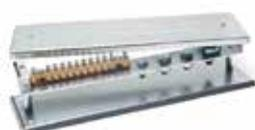
**große Ausführung, Klemmschiene 35x4 mm, fv, Grundplatte und Deckel aus Stahlblech, Anschlüsse bestehend aus:** 1xRundleiter 8–10mm, 2xErdungsband 40x4 mm, 1xKupferseil bis 50mm<sup>2</sup>, 12xLeitung bis 16mm<sup>2</sup>
