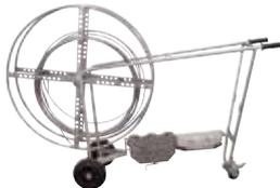
10 Richtrollen, fahrbar auf Gummirädern, mit Drahtspuleinrichtung, Verarbeitungsmöglichkeit von Ringen mit ID 450–800 mm und Ringbreiten bis 150 mm (auch zum Abspulen von Bandstahl geeignet)
