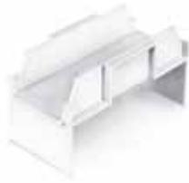
**Einbaudose** für DIN-Geräte; weiß (RAL 9010), zum Einrasten, mit vier Befestigungsdomen für selbstschneidende Schrauben Ø 2,9x13 mm, Boden und Seitenteile ausbrechbar
