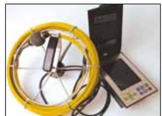
**Rohrkamera Kati KIS 50**, Rohr-Inspektionssystem mit Polykat-Glasfaserprofil Ø4,5 mm, Länge 40 m; einsetzbar in Rohren ab Ø30 mm bis max. Ø150 mm, bogengängig bei NW50 bis 80°, Kamerakopf aus Edelstahl Ø27 mm, nanobeschichtetes, kratzfestes Mineralglas, wasserdicht bis max. 4bar, Lichtempfindlichkeit des Kamera-Modus: 0,05 Lux, Objektiv: Weitwinkel 87°, 15 Ultra Powerlight LEDs sorgen für bestmögliche Ausleuchtung.
