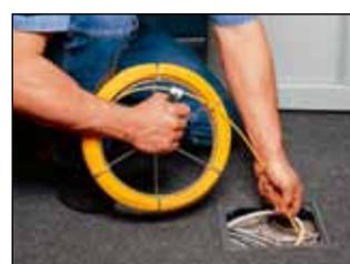
**Minimax**, Kabeleinziehgerät mit Polykat-Glasfibreinziehband Ø 4,5 mm; Anfangshülsen an beiden Bandenden inkl. Führungskopf mit Öse, Speicherkorb aus Aluminium, verzinktes Stahlrohrgestell mit Handgriff.
