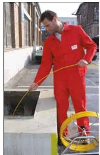
**Kabel-Jet**, Kabeleinziehgerät mit Polykat-Glasfibereinziehband Ø7,2mm; Anfangshülsen mit Gewinde M12 an beiden Bandenden. Verzinktes Stahlrohrgestell, klappbar, integrierte Bremse
